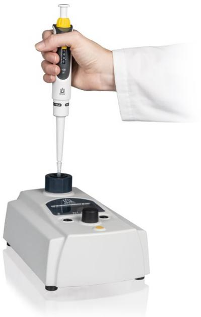
Dichtheitsprüfung mit der BRAND PLT unit
